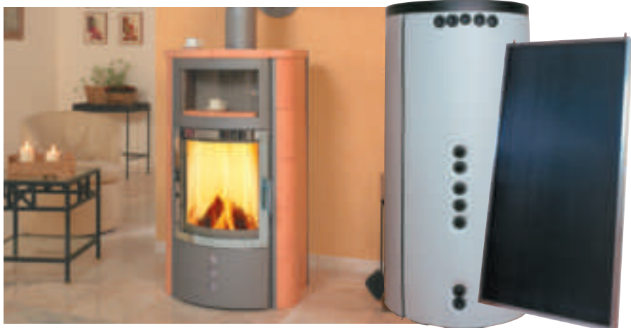
Wasserführender Kaminofen HARK 17 WW GT ECOplus mit 150 Liter Brauchwasser-Pufferspeicher und drei Solarkollektoren, sowie Anschluss-Leitungen, Ausdehnungsgefäße und Pumpen (nicht vormontiert).
