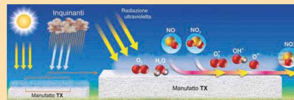
Il principio della fotocatalisi applicata ai materiali cementizi The principle of photocatalysis applied to cement materials
